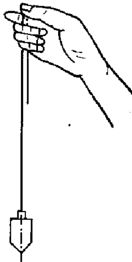
Hình 1-8: Cách cầm dây dọi
