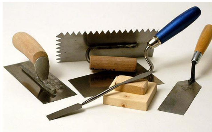
Hình 1-8: Dụng cụ trát (Plaster equipment)
