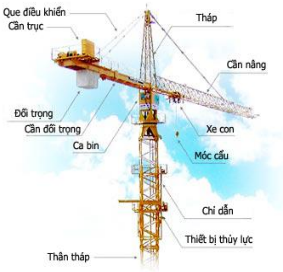
Hình 3-1: Cầu tháp (Crane)
